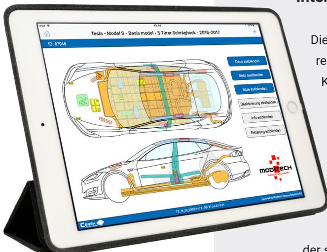
Die interaktive Darstellung zeigt alle Rückhaltesysteme sowie andere relevante Komponenten, z.B. die Fahrzeugbatterie, Verstärkungen, Kraftstofftank. Im Falle eines alternativ angetriebenen Fahrzeugs wird außerdem direkt ein Hinweisbildschirm eingeblendet.
